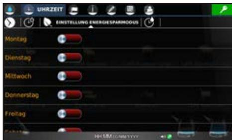
In der Abbildung wird die Grundeinstellung der Stand-by-Funktion angezeigt (Der Stand-by-Betrieb ist für alle Wochentage deaktiviert).
