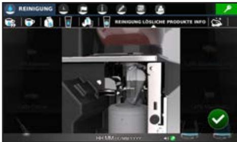
Auf dem Touchscreen werden die durchzuführenden Schritte für die Reinigung des Mixers angezeigt.
