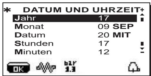
Bringen Sie den Cursor (dunkle Linie) mithilfe der Tasten ▲ und ▼ auf die zu ändernde Zeile und drücken Sie anschließend die Taste ►; die Darstellung des Cursors ändert sich in → und die Farbe der ausgewählten Zeile kann über die Tasten ▲ und ▼ geändert werden.
