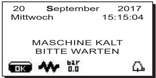
3 Während des Wartens auf die Betriebsbereitschaft der Maschine die Filterhalter in die Abgabeeinheiten einstecken. Die Maschine ist betriebsbereit, wenn am Display der vorgesehene Betriebsdruck angezeigt wird:
