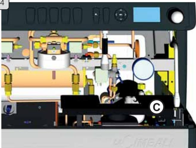
Lösen Sie die beiden Schrauben, und nehmen Sie Die Abdeckung (C) ab.
