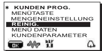
Den Cursor (dunkle Linie) auf Höhe der betreffenden Zeile positionieren, indem die Tasten ▲ und ▼ verwendet werden, dann die Taste ► drücken:
