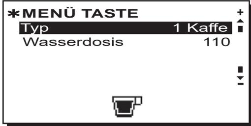
Jede Einheit wird über Drucktasten gesteuert, die für jede Taste das Speichern der gewünschten Abgabemenge ermöglichen.
