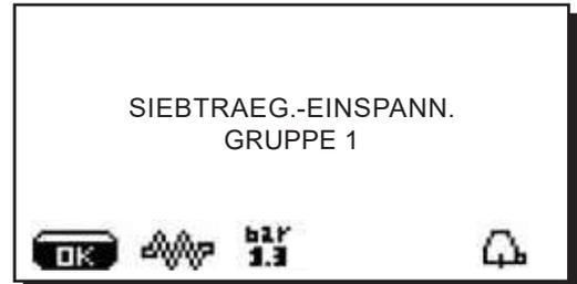
In dem Moment, in dem die Meldung „SIEBTRÄGER EINSpanNEN - GRUPPE 1“ erscheint, wird die Sperrmeldung bezüglich der Einheit 1 ausgeblendet. Die Sperrmeldungen der noch zu spülenden Einheiten werden im Wechsel weiterhin angezeigt.
