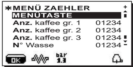
3 Durch Drücken einer beliebigen Abgabetaste bleibt die dazugehörige LED eingeschaltet und das Display zeigt die Anzahl der durch Drücken dieser Taste erfolgten Abgaben an:
