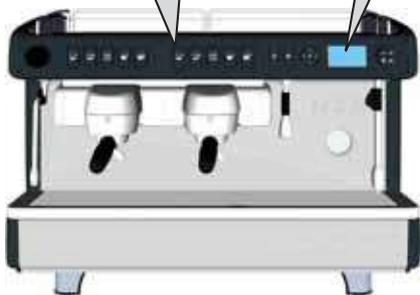
Die ausgewählten Zähler können durch Drücken der Taste **▶** und dann der Taste **▲** oder **▼** nullgesetzt werden.
