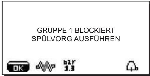
Die Nummer der „gesperrten Einheit“ wird im Wechsel angezeigt und hängt von der Anzahl der Maschineneinheiten ab.
